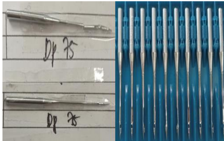
Gambar 2. Perbedaan jarum patah dan jarum baru
