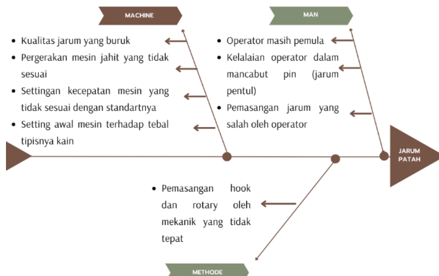
Gambar 5. Fishbone diagram untuk analisa jarum patah
