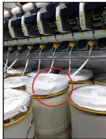
Gambar 3. Cara penataan can yang kurang teratur
