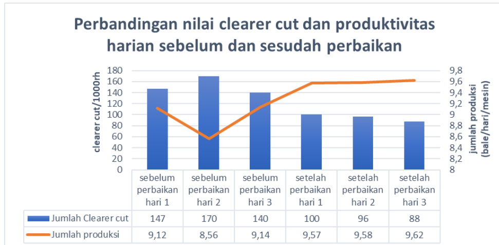
Gambar 6. Perbandingan nilai clearer cut dan efisiensi produktivitas sebelum dan sesudah perbaikan
