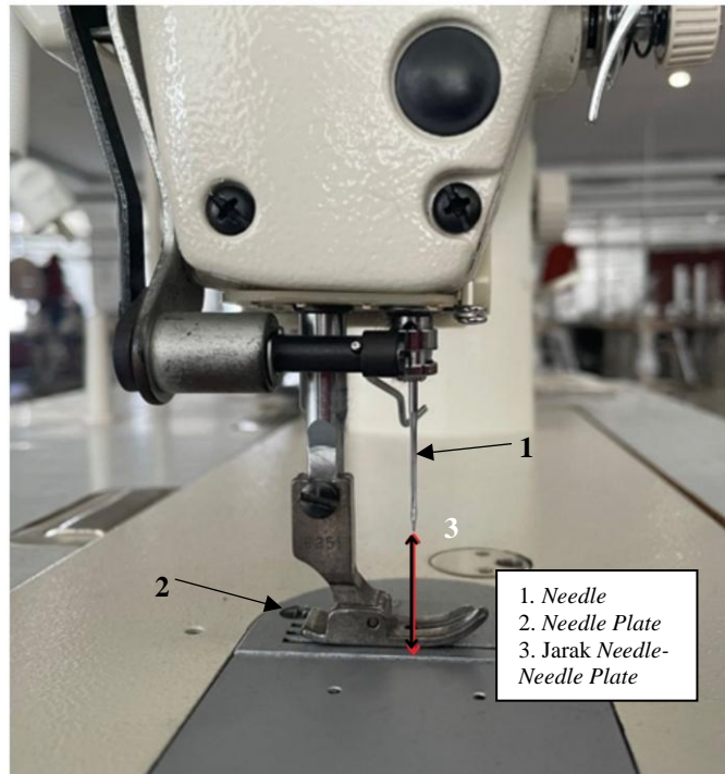
Gambar 2. Penyetelan jarak needle-needle plate
