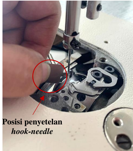
Gambar 3. Penyetelan dengan feeler gauge
