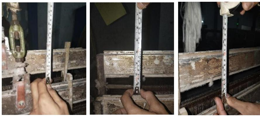
**Gambar 3.** Penyetelan tinggi kamran di mesin tenun *shuttle* RRC GA615075 di PT Sekar Lima Pratama;
