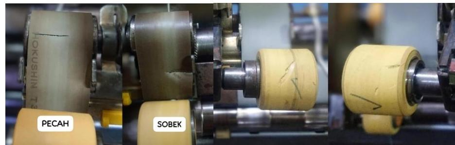
Gambar 3. Cacat pada top apron dan top roll
