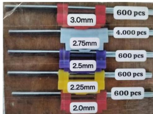
**Gambar 3.** Perangkat *pin spacer* pada peralatan *compact ring-spinning* dengan berbagai ukuran (dokumentasi di PT Tantra Textile Industry)
