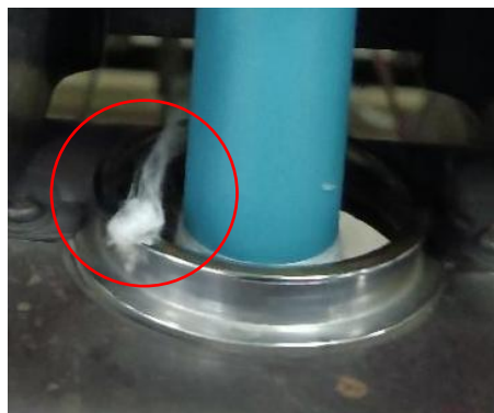
Gambar 9. Traveller cacat karena bandotan
