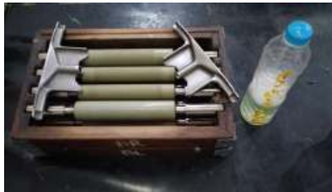
Gambar 4.5 Top roller yang sudah dilakukan perawatan
